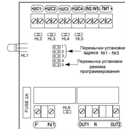
Рис.3 - Расположение индикаторов и перемычек на плате БКК
