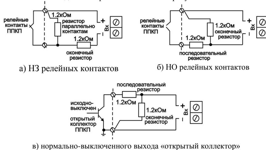
**Рис.1 - Схема подключения контактов к технологическим шлейфам**
